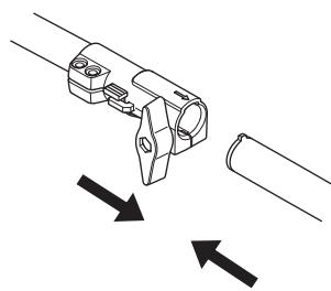
Перед использованием узла, хорошо затяните ручку.
